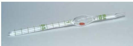
**Figura 2.** Pipeta de dilución para glóbulos rojos y plaquetas.
